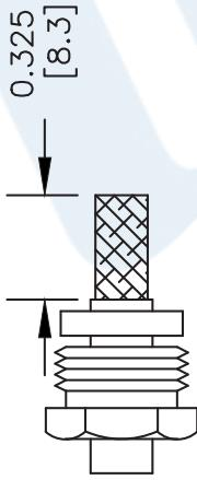
FORM BRAID OVER CLAMP NUT (3). TRIM BRAID BACK TO SHOULDER. CUT DIELECTRIC TO DIMENSION SHOWN. DO NOT NICK CENTER CONDUCTOR. SOLDER CONTACT TO CENTER CONDUCTOR. REMOVE EXCESS SOLDER. DO NOT OVER HEAT DIELECTRIC. INSERT CABLE ASSEMBLY INTO BODY & TIGHTEN.
