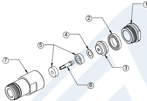
1. SLIDE CLAMP NUT (1), GASKET (2) AND WASHER (3) OVER CABLE. STRIP CABLE AS SHOWN. DO NOT NICK BRAID WHILE CUTTING JACKET. TAPER END OF BRAID TO PERMIT ASSEMBLY OF CLAMP.
