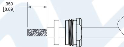
2. SLIDE BRAID CLAMP (3) OVER BRAID & SEAT AGAINST CABLE. FORM BRAID OVER CLAMP NUT. TRIM BRAID BACK TO SHOULDER. CUT DIELECTRIC & CENTER CONDUCTOR TO DIMENSION SHOWN. DO NOT NICK CENTER CONDUCTOR
