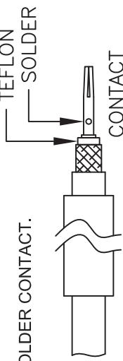
4. INSTALL CABLE INTO BODY AND SOLDER CABLE TO BODY AS SHOWN, SLIDE HEAT-SHRINK TUBE TOWARDS BODY SHOULDER AND SHRINK TO FIT.
