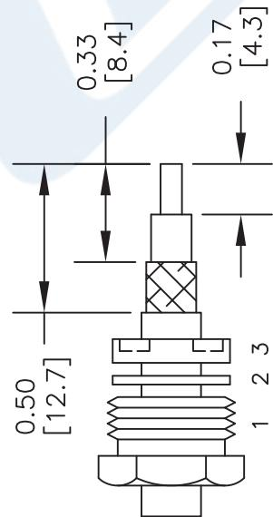
3. A) SLIDE BRAID CLAMP OVER BRAID UNTIL IT STOPS ON CABLE JACKET.
