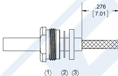
2. SLIDE BRAID CLAMP ④ OVER BRAID & SEAT AGAINST CABLE. FORM BRAID OVER CLAMP NUT. TRIM BRAID BACK TO SHOULDER. CUT DIELECTRIC & CENTER CONDUCTOR TO DIMENSION SHOWN. DO NOT NICK CENTER CONDUCTOR.
