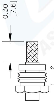
2. FORM BRAID OVER CLAMP NUT (3). TRIM BRAID BACK TO SHOULDER. CUT DIELECTRIC TO DIMENSION SHOWN. DO NOT NICK CENTER CONDUCTOR. SOLDER CONTACT TO CENTER CONDUCTOR. REMOVE EXCESS SOLDER. DO NOT OVER HEAT DIELECTRIC. INSERT CABLE ASSEMBLY INTO BODY & TIGHTEN.
