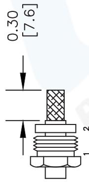
FORM BRAID OVER CLAMP NUT (3). TRIM BRAID BACK TO SHOULDER. CUT DIELECTRIC TO DIMENSION SHOWN. DO NOT NICK CENTER CONDUCTOR. SOLDER CONTACT TO CENTER CONDUCTOR. REMOVE EXCESS SOLDER. DO NOT OVER HEAT DIELECTRIC. INSERT CABLE ASSEMBLY INTO BODY & TIGHTEN.
