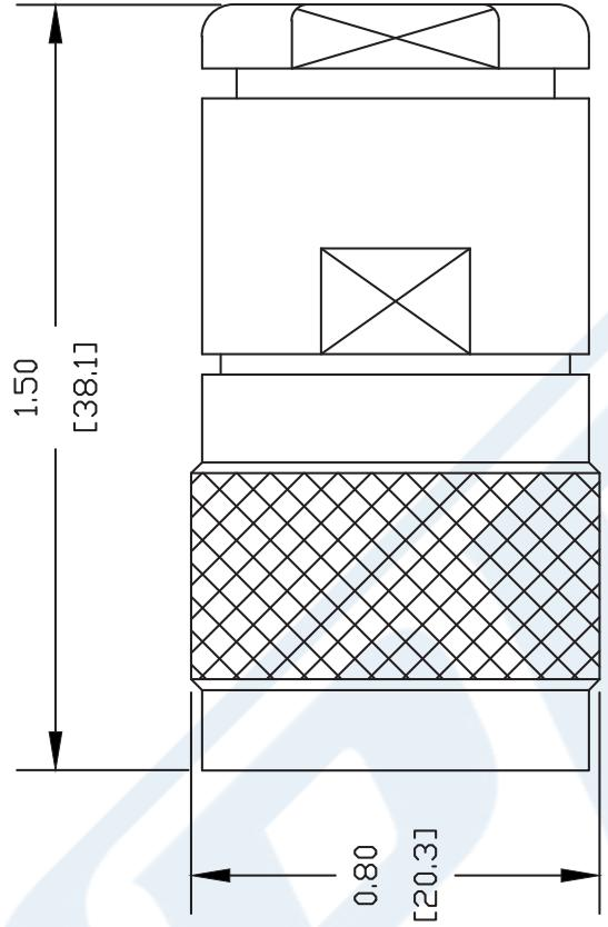
2. FORM BRAID OVER CLAMP NUT (3). TRIM BRAID BACK TO SHOULDER. CUT DIELECTRIC TO DIMENSION SHOWN. DO NOT NICK CENTER CONDUCTOR. SOLDER CONTACT TO CENTER CONDUCTOR. REMOVE EXCESS SOLDER. DO NOT OVER HEAT DIELECTRIC. INSERT CABLE ASSEMBLY INTO BODY & TIGHTEN.
