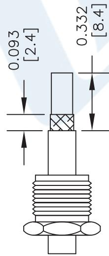
2. SLIDE CLAMP OVER DIELECTRIC AND UNDER BRAID UNTIL JACKET STOPS AGAINST SHOULDER. TWO SLITS IN THE JACKET 180° APART.
