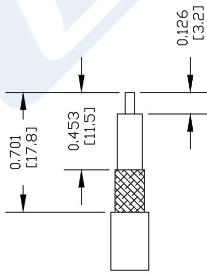
2. ADD EXTENSION (2) BY SLIDING EXTENSION BETWEEN BRAID & DIELECTRIC. SLIDE FERRULE (1) OVER BRAID & CRIMP.
