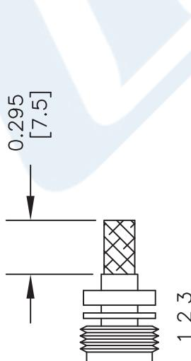
2. FORM BRAID OVER CLAMP NUT (4). TRIM BRAID BACK TO SHOULDER. CUT DIELECTRIC & CENTER CONDUCTOR TO DIMENSION SHOWN. DO NOT NICK CENTER CONDUCTOR. SLIDE DIELECTRIC BEAD OVER CENTER CONDUCTOR & SOLDER CONTACT TO CENTER CONDUCTOR. REMOVE EXCESS SOLDER. DO NOT OVER HEAT DIELECTRIC. INSERT CABLE ASSEMBLY INTO BODY & TIGHTEN.
