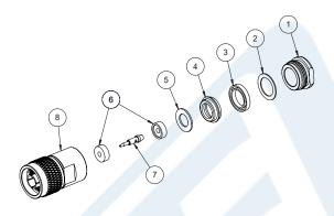
1. SLIDE CLAMP NUT (1), THIN-WASHER (2) & GASKET (3) OVER CABLE. STRIP CABLE AS SHOWN. DO NOT NICK BRAID WHILE CUTTING JACKET. TAPER END OF BRAID TO PERMIT ASSEMBLY OF CLAMP.
