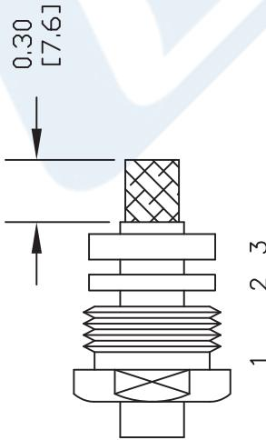
2. FORM BRAID OVER CLAMP NUT (4). TRIM BRAID BACK TO SHOULDER. CUT DIELECTRIC TO DIMENSION SHOWN. DO NOT NICK CENTER CONDUCTOR. SOLDER CONTACT TO CENTER CONDUCTOR. REMOVE EXCESS SOLDER. DO NOT OVER HEAT DIELECTRIC. INSERT CABLE ASSEMBLY INTO BODY & TIGHTEN.
