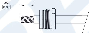
2. SLIDE BRAID CLAMP (3) OVER BRAID & SEAT AGAINST CABLE. FORM BRAID OVER BRAID CLAMP (3). TRIM BRAID BACK TO SHOULDER. CUT DIELECTRIC & CENTER CONDUCTOR TO DIMENSIONS SHOWN. DO NOT NICK CENTER CONDUCTOR.
