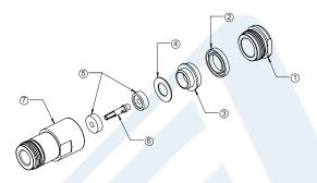
SLIDE CLAMP NUT (1) AND GASKET (2) OVER CABLE. STRIP CABLE AS SHOWN. DO NOT NICK BRAID WHILE CUTTING JACKET. TAPER END OF BRAID TO PERMIT ASSEMBLY OF CLAMP.
