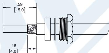
2. SLIDE BRAID CLAMP (4) OVER BRAID & SEAT AGAINST CABLE. FORM BRAID OVER CLAMP NUT (4). TRIM BRAID BACK TO SHOULDER. CUT DIELECTRIC & CENTER CONDUCTOR TO DIMENSION SHOWN. DO NOT NICK CENTER CONDUCTOR.
