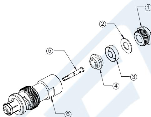
1. SLIDE CLAMP NUT (1), WASHER (2) & GASKET (3) OVER CABLE. STRIP CABLE AS SHOWN. DO NOT NICK BRAID WHILE CUTTING JACKET. TAPER END OF BRAID TO PERMIT ASSEMBLY OF CLAMP.
