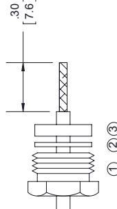
2. SLIDE BRAID CLAMP (4) OVER BRAID & SEAT AGAINST CABLE. FORM BRAID OVER CLAMP NUT. TRIM BRAID BACK TO SHOULDER. CUT DIELECTRIC & CENTER CONDUCTOR TO DIMENSION SHOWN. DO NOT NICK CENTER CONDUCTOR.
