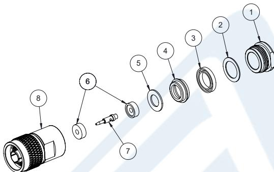
1. SLIDE CLAMP NUT ①, THIN-WASHER ② & GASKET ③ OVER CABLE. STRIP CABLE AS SHOWN. DO NOT NICK BRAID WHILE CUTTING JACKET. TAPER END OF BRAID TO PERMIT ASSEMBLY OF CLAMP.
