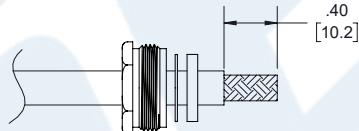
2. SLIDE BRAID CLAMP ④ OVER BRAID & SEAT AGAINST CABLE. FORM BRAID OVER CLAMP NUT. TRIM BRAID BACK TO SHOULDER. CUT DIELECTRIC & CENTER CONDUCTOR TO DIMENSION SHOWN. DO NOT NICK CENTER CONDUCTOR.
