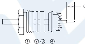
2. SLIDE BRAID CLAMP ④ OVER BRAID & SEAT AGAINST CABLE. FORM BRAID OVER CLAMP NUT. TRIM BRAID BACK TO SHOULDER. CUT DIELECTRIC & CENTER CONDUCTOR TO DIMENSION SHOWN. DO NOT NICK CENTER CONDUCTOR.
