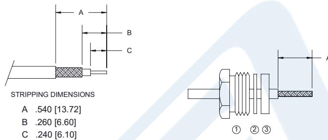
1. SLIDE CLAMP NUT ①, THINNER WASHER ② & GASKET ③ OVER CABLE. STRIP CABLE AS SHOWN. DO NOT NICK BRAID WHILE CUTTING JACKET. TAPER END OF BRAID TO PERMIT ASSEMBLY OF CLAMP.
