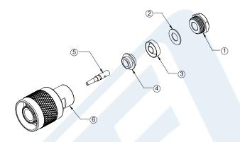
1. SLIDE CLAMP NUT (1), WASHER (2) & GASKET (3) OVER CABLE. STRIP CABLE AS SHOWN. DO NOT NICK BRAID WHILE CUTTING JACKET. TAPER END OF BRAID TO PERMIT ASSEMBLY OF CLAMP.
