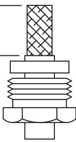
1. SLIDE CLAMP NUT (1) & GASKET (2) OVER CABLE. STRIP CABLE AS SHOWN. DO NOT NICK BRAID WHILE CUTTING JACKET. TAPER END OF BRAID TO PERMIT ASSEMBLY OF BRAID CLAMP (3) SLIDE BRAID CLAMP (3) OVER BRAID & SEAT AGAINST CABLE.
