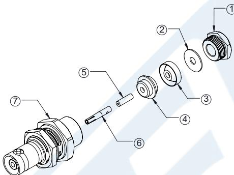
1. SLIDE CLAMP NUT (1), WASHER (2) & GASKET (3) OVER CABLE. STRIP CABLE AS SHOWN. DO NOT NICK BRAID WHILE CUTTING JACKET. TAPER END OF BRAID TO PERMIT ASSEMBLY OF CLAMP.
