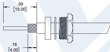
2. SLIDE BRAID CLAMP (4) OVER BRAID & SEAT AGAINST CABLE. FORM BRAID OVER CLAMP NUT (4). TRIM BRAID BACK TO SHOULDER. CUT DIELECTRIC & CENTER CONDUCTOR TO DIMENSION SHOWN. DO NOT NICK CENTER CONDUCTOR.
