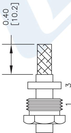
2. FORM BRAID OVER BRAID CLAMP (4). TRIM BRAID BACK TO SHOULDER. CUT DIELECTRIC & CENTER CONDUCTOR TO DIMENSION SHOWN. DO NOT NICK CENTER CONDUCTOR. SOLDER CONTACT TO CENTER CONDUCTOR. REMOVE EXCESS SOLDER. DO NOT OVER HEAT DIELECTRIC. INSERT CABLE ASSEMBLY INTO BODY & TIGHTEN.
