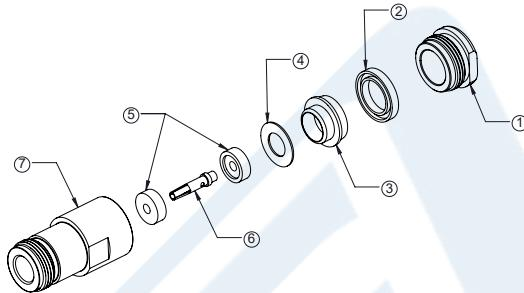
1. SLIDE CLAMP NUT (1) AND GASKET (2) OVER CABLE. STRIP CABLE AS SHOWN. DO NOT NICK BRAID WHILE CUTTING JACKET. TAPER END OF BRAID TO PERMIT ASSEMBLY OF CLAMP.
