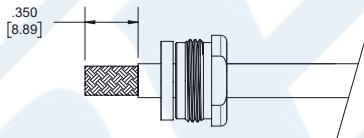
2. SLIDE BRAID CLAMP (3) OVER BRAID & SEAT AGAINST CABLE. FORM BRAID OVER BRAID CLAMP (3). TRIM BRAID BACK TO SHOULDER. CUT DIELECTRIC & CENTER CONDUCTOR TO DIMENSIONS SHOWN. DO NOT NICK CENTER CONDUCTOR.
