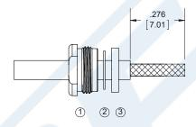
2. SLIDE BRAID CLAMP (4) OVER BRAID & SEAT AGAINST CABLE. FORM BRAID OVER CLAMP NUT. TRIM BRAID BACK TO SHOULDER. CUT DIELECTRIC & CENTER CONDUCTOR TO DIMENSION SHOWN. DO NOT NICK CENTER CONDUCTOR.
