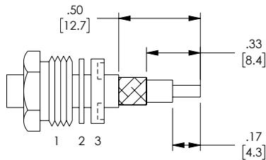
3. A) SLIDE BRAID CLAMP OVER BRAID UNTIL IT STOPS ON CABLE JACKET.
