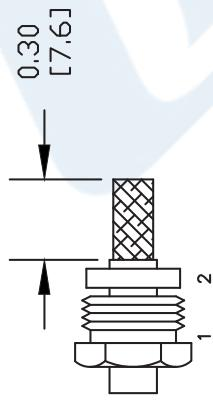
FORM BRAID OVER CLAMP NUT (3). TRIM BRAID BACK TO SHOULDER. CUT DIELECTRIC TO DIMENSION SHOWN. DO NOT NICK CENTER CONDUCTOR. SOLDER CONTACT TO CENTER CONDUCTOR. REMOVE EXCESS SOLDER. DO NOT OVER HEAT DIELECTRIC. INSERT CABLE ASSEMBLY INTO BODY & TIGHTEN.
